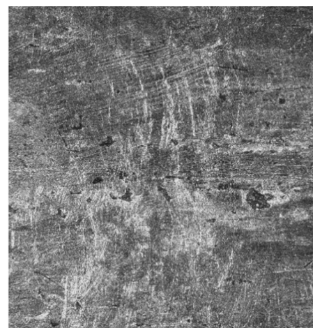
Рис. 9. Следы, оставленные отмычкой на внутренней части ротора (рамками отмечены дуговые потертости)
