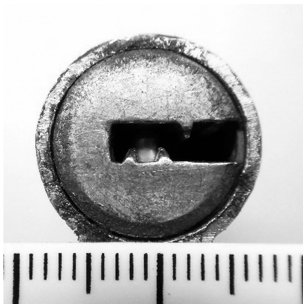
Рис. 1. Горизонтально расположенная ключевая скважина цилиндрического механизма
