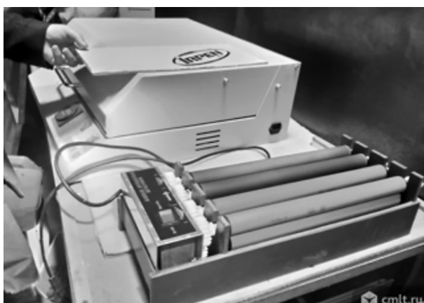
Рис. 15. Металлофотографическая печать: слева — станок для экспонирования и автоматический ЗИП процессор для проявления и закрепления; справа — шильда с маркировочными обозначениями
