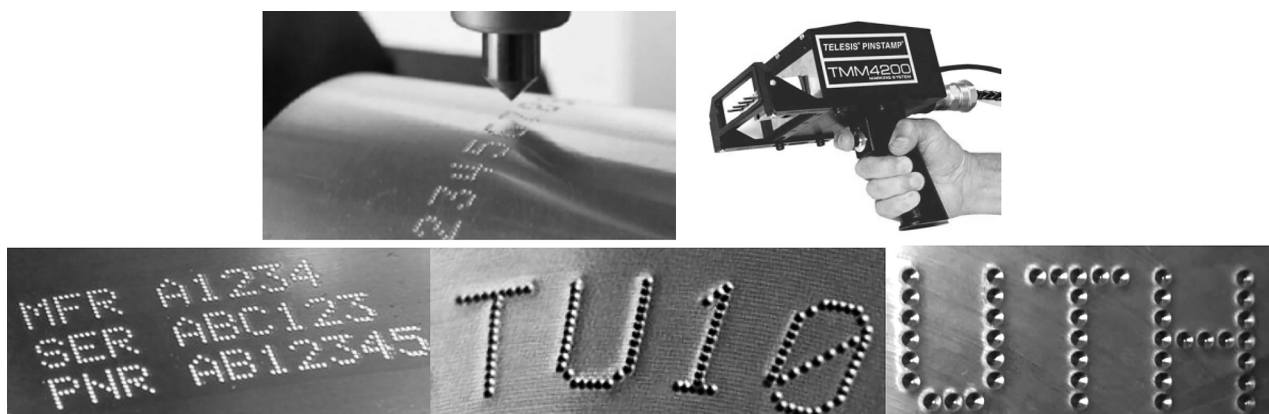
Рис. 4. Ударно-точечный способ: сверху — головка маркиратора в станке и ручной игольчатый пистолет; снизу — знаки маркировки
