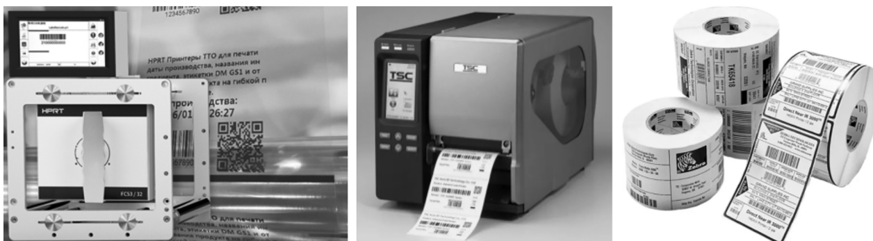
Рис. 16. Термотрансферная печать, слева направо: принтер для маркирования готовых упаковок; принтер для изготовления самоклеящихся этикеток; рулоны самоклеящихся этикеток
