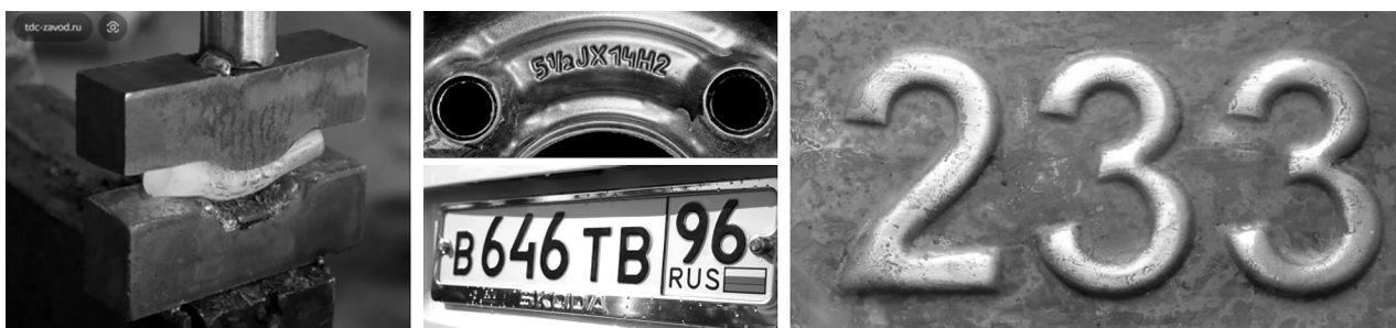
Рис. 9. Маркирование штампованием (знаки вдавленные и выпуклые)
