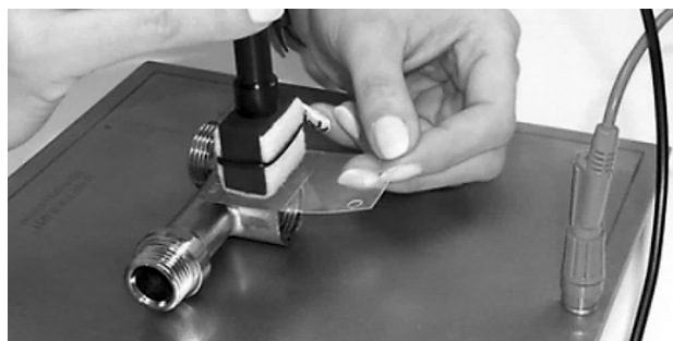
Рис. 14. Способ электрохимического нанесения информационных отметок
