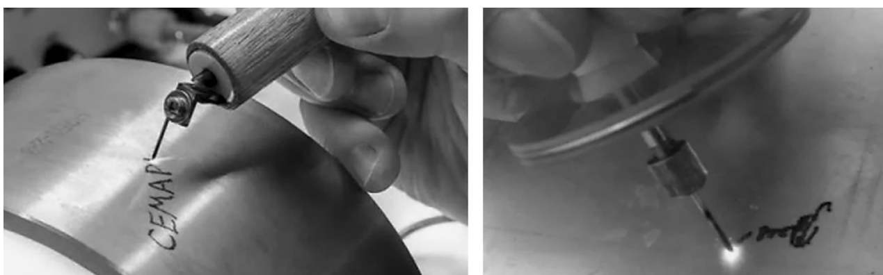
Рис. 12. Электроискровый способ маркирования
